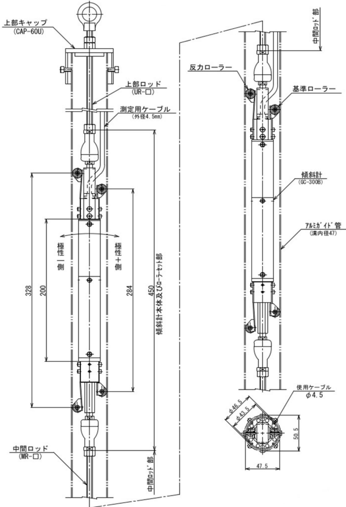
下図は、角パイプ内に傾斜計を設置した状態です。
