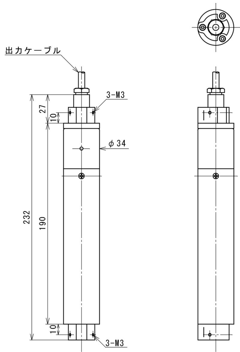
埋設型傾斜計 (DC-120B-B)
