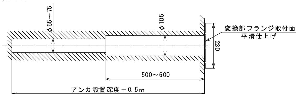
図-1 ボーリング孔の図
