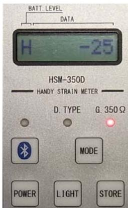
3) 「MODE」キーでセンサーに適したモードに切り替えます。
