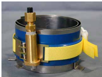
写真3 沈下素子（ボーリング孔用）：SSA-5
