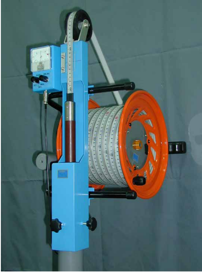
写真2 沈下素子（盛土用）：SSA-4
